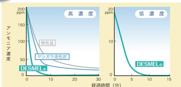
試験方法 ●試料の重さ: 1g ●試験容器: 1リットルテトラパック ●容器内のガス量: 1リットル ●ガス初期濃度: アンモニア 200ppm, 20ppm ●ガス測定方法: 北川式検知管 ((財) 日本紡績検査協会)
